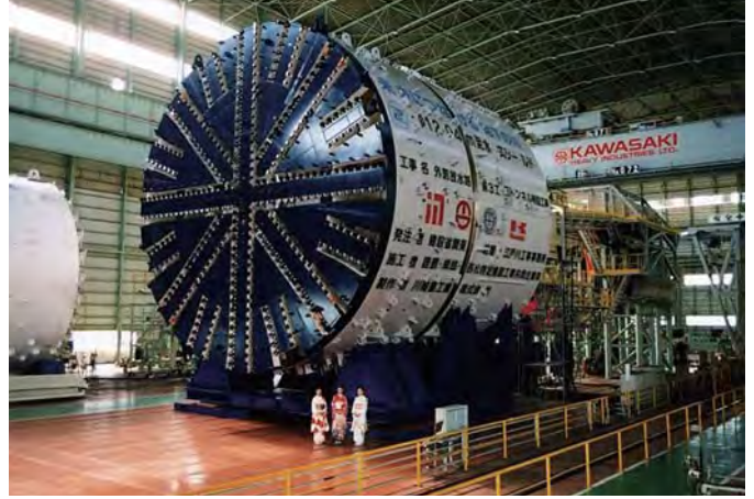
■巨大なシールドマシン。着物の女性との比較でその大きさが分かる
