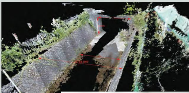
現地写真から3次元点群データを作成し、現地状況確認や構造物の計測などを行うことで設計業務に活かしている
